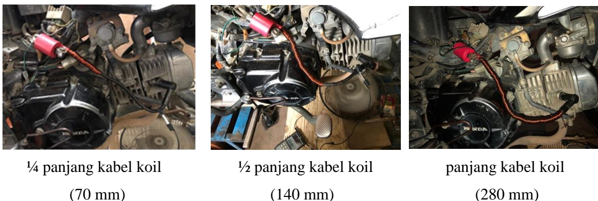
Gambar 1. Kawat ground strap pada kabel koil
