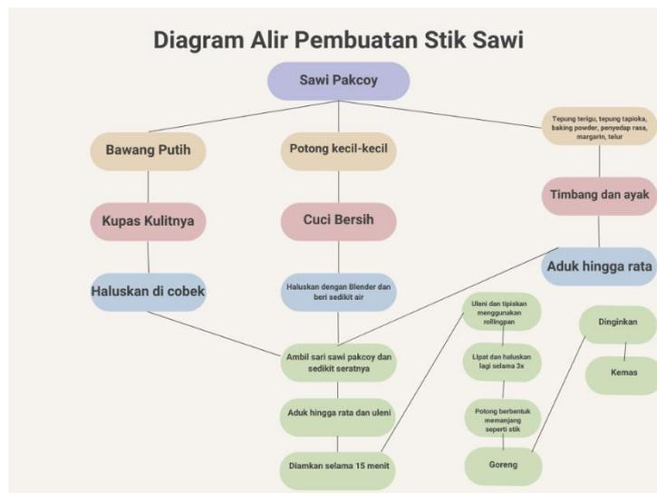
**Gambar 1. Diagram Alir Pembuatan Stik Sawi**
