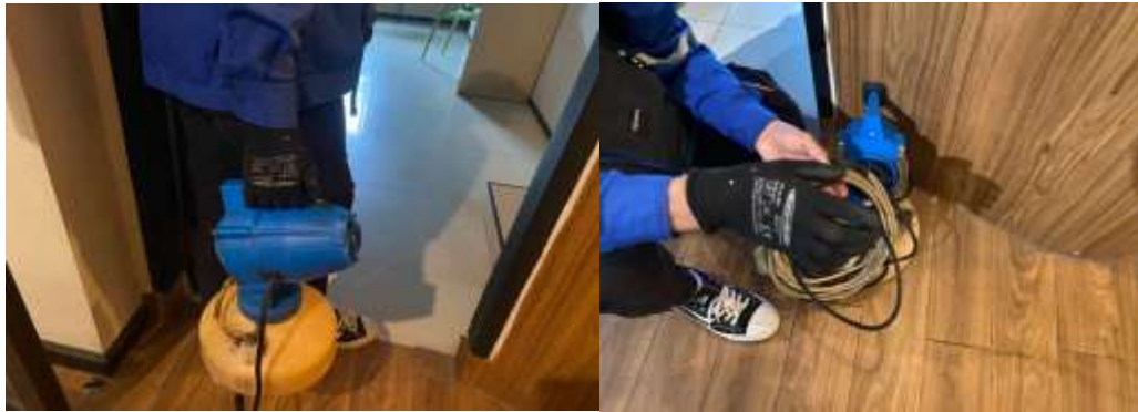
Gambar 1. Pekerja menggunakan sarung tangan saat mengoperasikan alat Ultra Low Volume (ULV) sebagai upaya mengurangi paparan getaran pada tangan.
